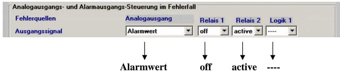
Nach Auftreten eines Fehlers (1. Fehler) im Analogausgang werden entsprechend den Funktionseinstellungen in der Maske für **Überwachungsmaßnahmen** die Ausgänge gesteuert.
