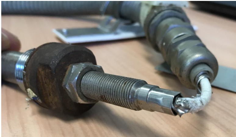
Afbeelding 2. Beschadiging probe kabel
