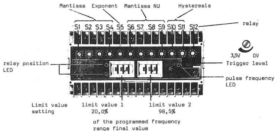
Elektronische Tachometer/Electronic Tachometers/Tachymetres Electroniques FT 1300
