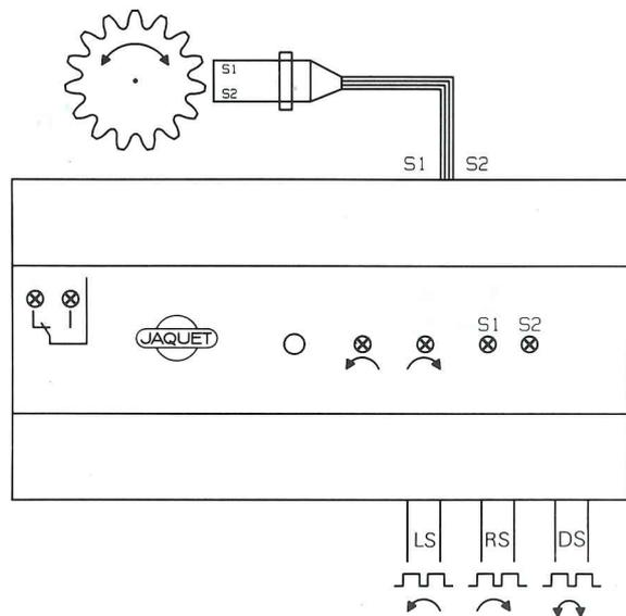
DS: Dauersignal Rechteckspannung +12 Vpp, Impedanz 200 Ohm
