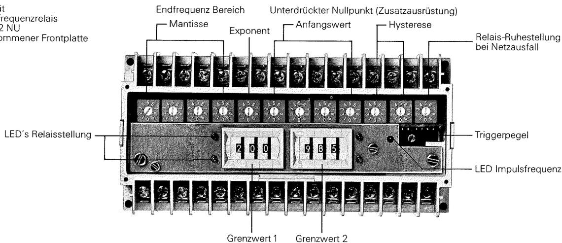
An den Frequenzeingang können sowohl aktive wie passive Impulsgeber angeschlossen werden. Für passive Geber wie z.B. Ferrostat-, HF- und weitere Zweidrahtgeber (z.B. NAMUR) sowie fotoelektrische Geber oder Impulsgeber mit Signalverstärker liefert eine eingebaute Speisequelle die erforderliche Gleichspannung (+12 V =, 60 mA).
